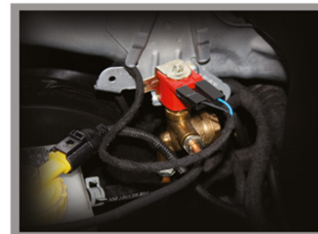
УСТАНОВКА ГАЗОВОГО КЛАПАНА НА АВТОМОБИЛЬ
