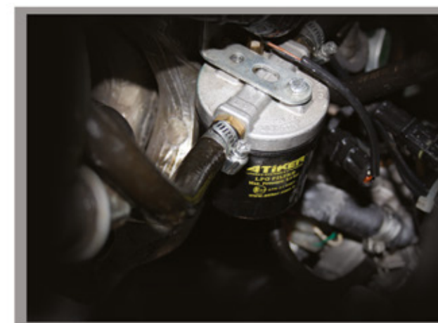
УСТАНОВКА ФИЛЬТРА ТОНКОЙ ОЧИСТКИ НА АВТОМОБИЛЬ
