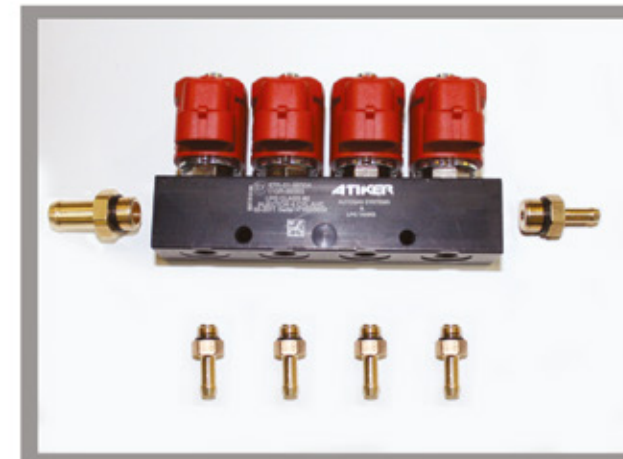
УСТАНОВКА ШТУЦЕРОВ НА ПЛАНКУ ГАЗОВЫХ ФОРСУНОК
