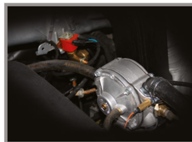
УСТАНОВКА РЕДУКТОРА НА АВТОМОБИЛЬ
