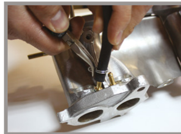
УСТАНОВКА РУКАВОВ НА КОЛЛЕКТОР
