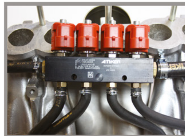
УСТАНОВЛЕННЫЕ ГАЗОВЫЕ ФОРСУНКИ
