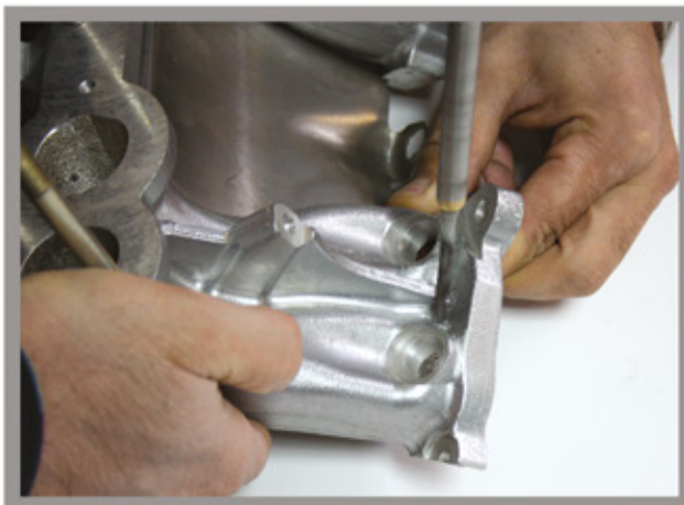
РАЗМЕТКА ОТВЕРСТИЙ ПЕРЕД УСТАНОВКОЙ РАСПЫЛИТЕЛЕЙ
