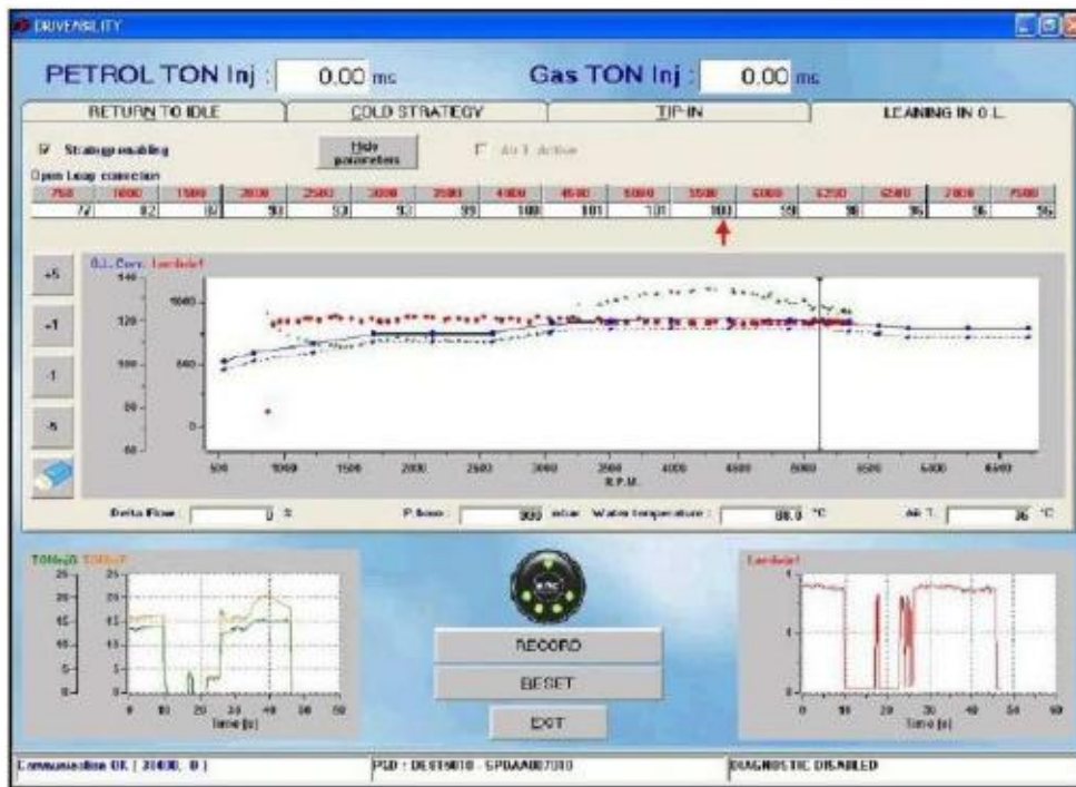
Фиг. 5-15 Настройки: управляемость — дорожные испытания в OPEN LOOP, №1
