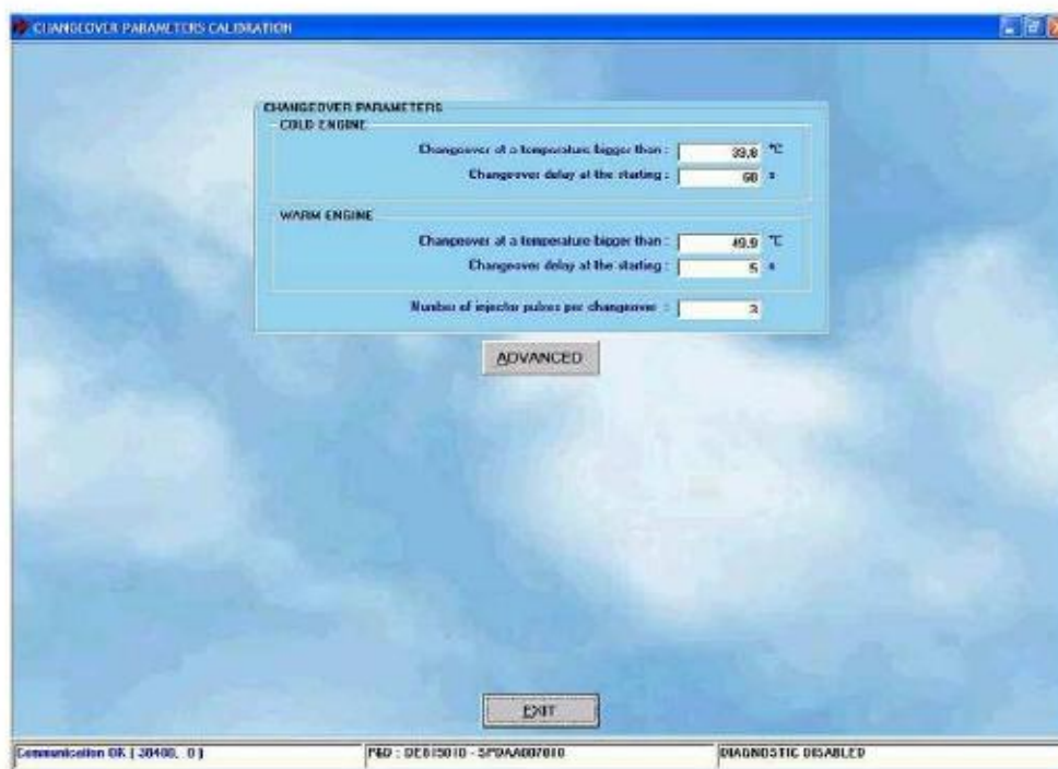
Фиг. 5-24 Настройки: калибровка параметров переключения режимов
