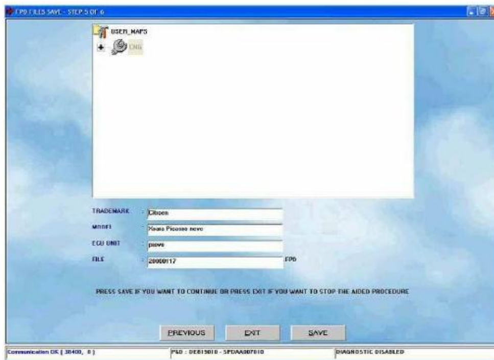
Фиг. 4-15 Полуавтоматическая процедура: окончание процедуры программирования
