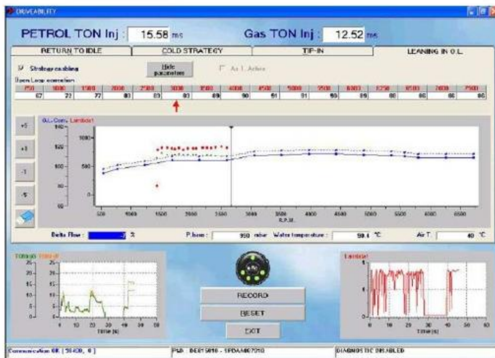
Фиг. 5-16 Настройки: управляемость — значение дельта-потока -7%
