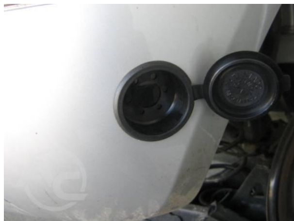
Рис. 1.3.2 Монтаж крышки заправочного клапана
