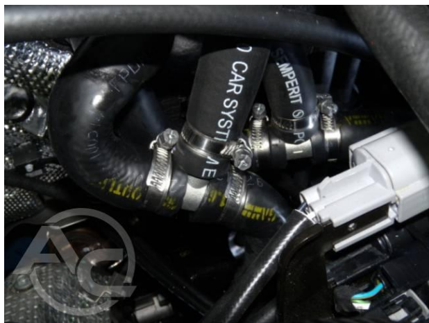
Рис. 1.3.27 Подключение редуктора к системе охлаждения
