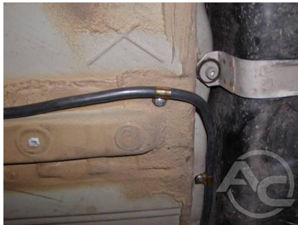
Рис. 1.3.22 Крепление с помощью металлических хомутов
