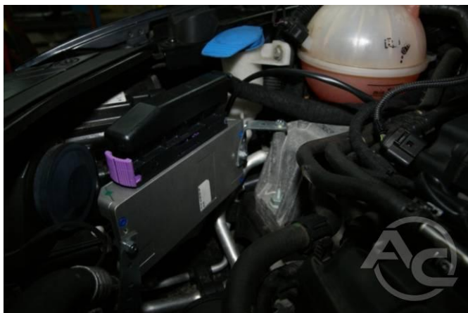
Рис. 1.3.31 Внешний вид установленного контроллера
