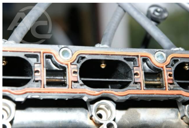
Рис. 1.3.34 Место монтажа сопел (вид изнутри канала коллектора)
