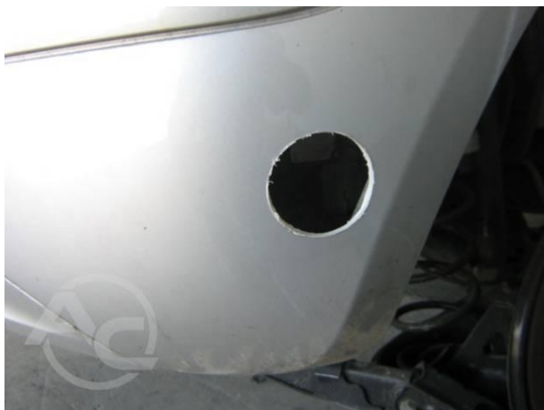
Рис. 1.3.1 Изготовление отверстия в бампере
