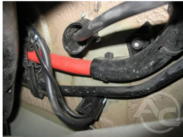
Рис. 1.3.17 Выход втулки под транспортное средство
