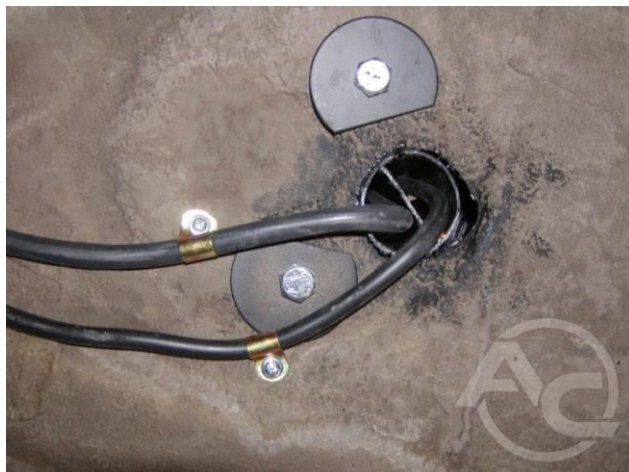
Рис. 1.3.20 Прохождение газопроводов через шасси
