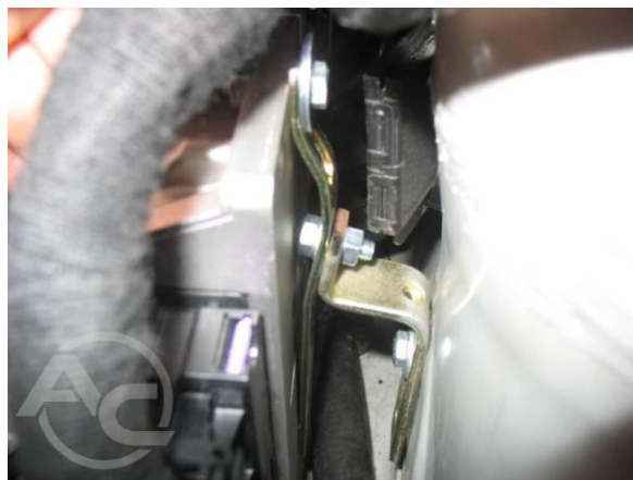
Рис. 1.3.32 Внешний вид крепления контроллера
