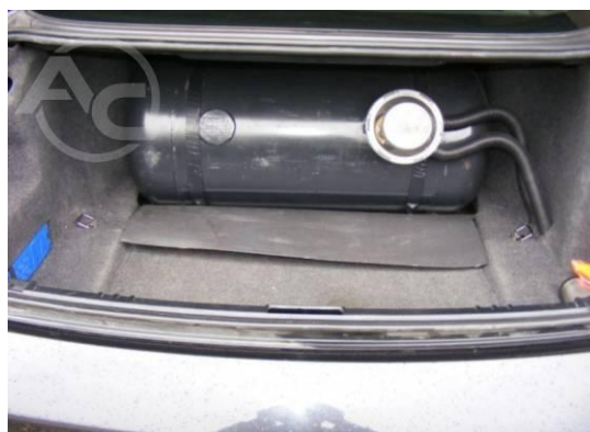
Рис. 1.3.8 Вид установленного бака
