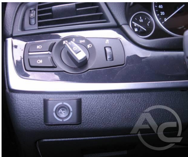
Рис. 1.3.37 Пример места монтажа переключателя В/Г
