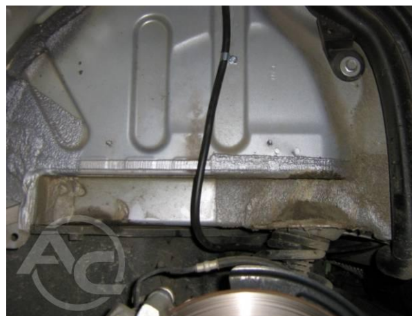
Рис. 1.3.6 Крепление шланга заправки
