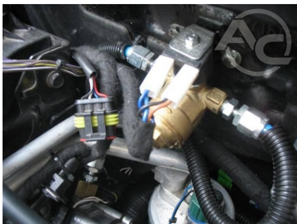
Рис. 1.3.23 Соединение проводки с электроклапаном.
