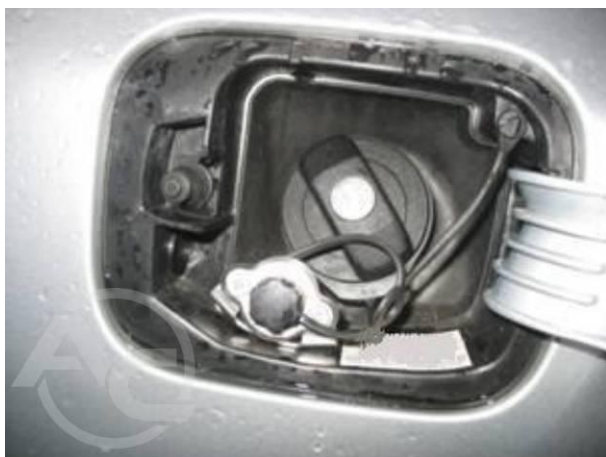
Рис. 1.3.5 Заправочный клапан в углублении заливного отверстия бензина
