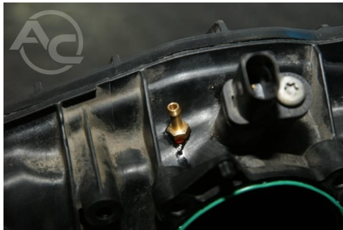
Рис. 1.3.35 Сопло разрежения, установленное в коллекторе
