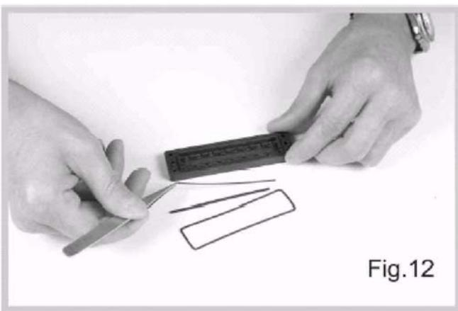
Снимите внешнюю уплотнительную прокладку, уплотнительный манжет и металлическую пластину с помощью пинцета или маленькой отвертки.
