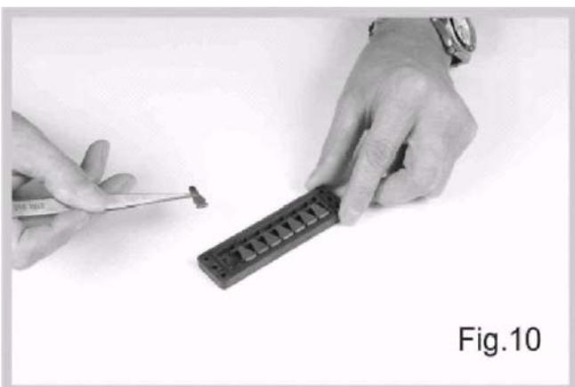
Вынуть язычки с помощью пинцета или маленькой отвертки и выложить их на рабочем месте в правильной последовательности. (Рис. 10-11).
