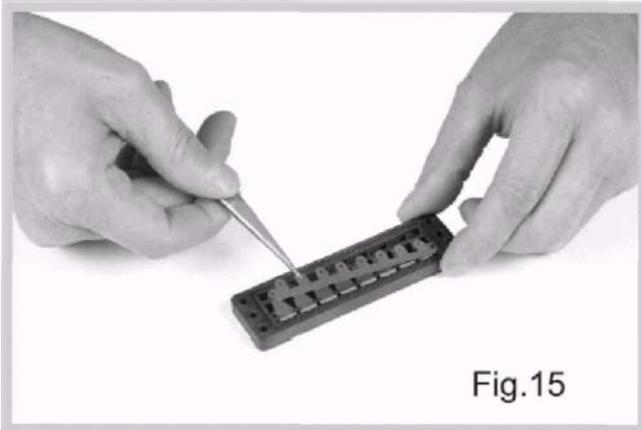
Установить на свое место металлический трафарет на два пластмассовых выступа, имеющих на корпусе блока, во избежание деформации или поломки.
