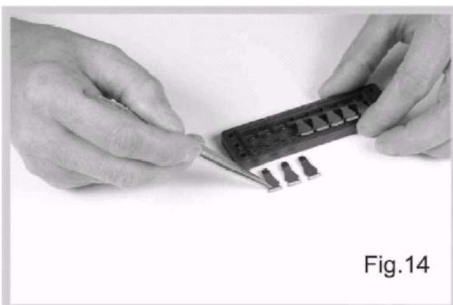
Аккуратно установите на свои места язычки и в порядке разборки уплотнительную прокладку, металлическую пластину и уплотнительный манжет.
