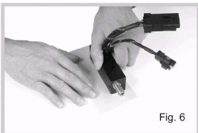
Приступить к очистке внутренней поверхности магистрали и её каналов, удаляя при этом имеющиеся в наличии масляные отложения и другие инородные тела с помощью сжатого воздуха. Аккуратно, с помощью впитывающей бумаги почистить места прилегания частей магистрали, а затем продуть сжатым воздухом.
